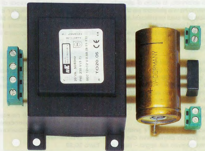
Fig.7 Foto dello stadio di alimentazione "non" stabilizzato come si presenta a montaggio ultimato. Questo alimentatore che eroga una tensione di circa 32 Volt e una corrente di 0,9 Amper può essere utilizzato per alimentare anche altri circuiti che richiedano questi valori di tensione e corrente.
