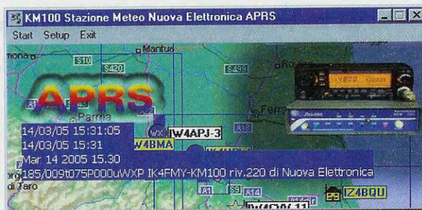
Fig.30 Come abbiamo spiegato nell'articolo, i dati provenienti dalla centralina vengono elaborati dal nostro programma in codici APRS per essere inviati nella rete. Per decodificare questi dati leggete il paragrafo "Come si legge il file WXPRS.TXT".
