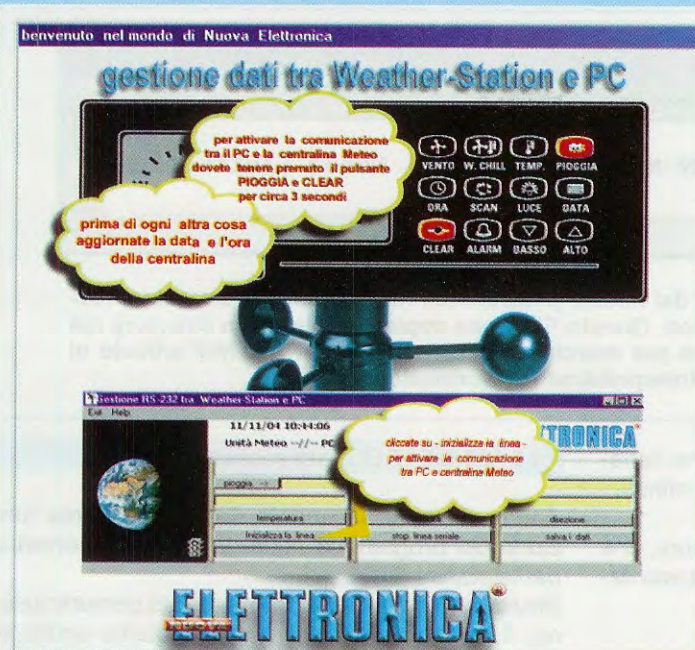
Fig.18 Per stabilire la connessione tra centralina KM.100 e computer dovete tenere premuti i tasti Pioggia e Clear per circa tre secondi. Per tutte le informazioni sulla configurazione del programma e le sue numerose funzioni di salvataggio ed elaborazione dei dati, vi consigliamo di leggere la rivista N.222.
