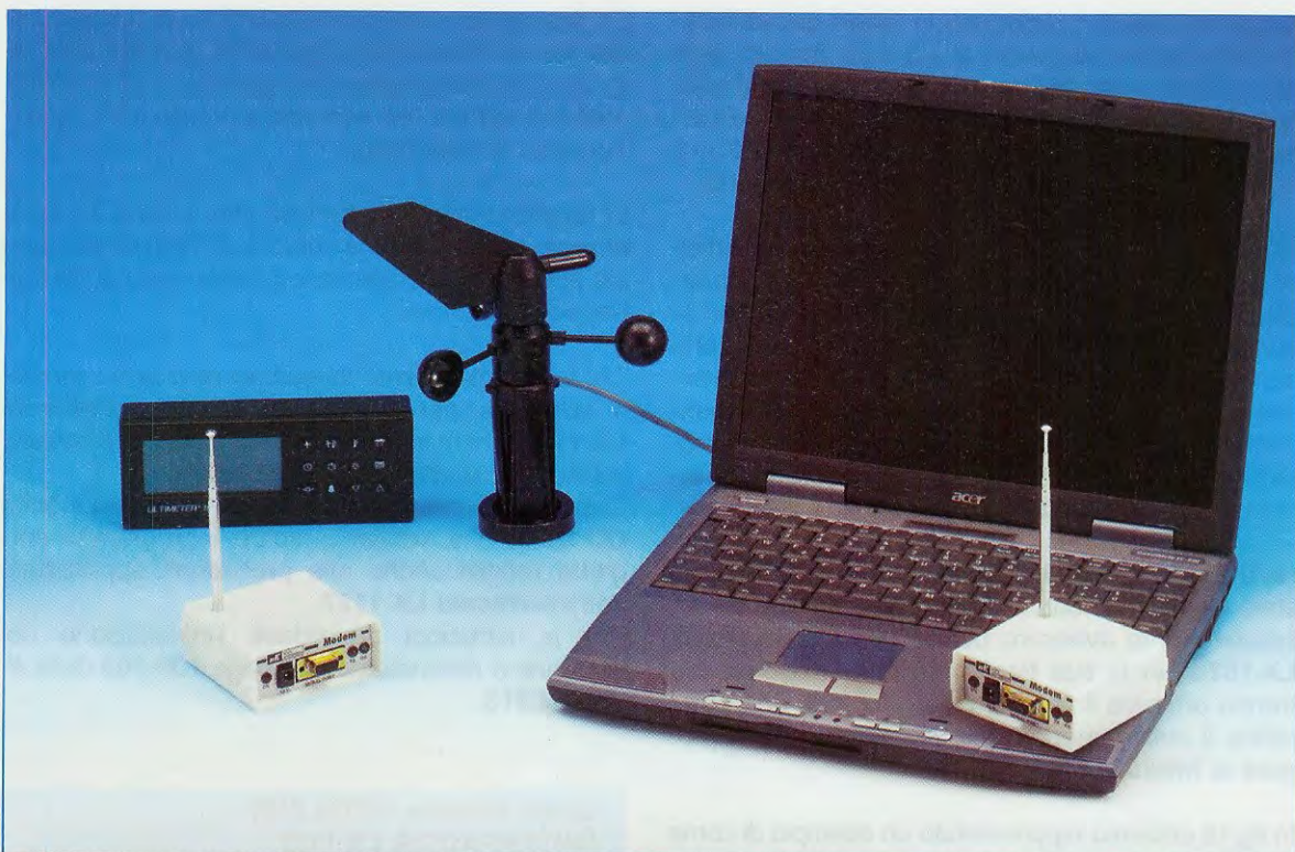
Fig.15 Coloro che desiderassero utilizzare un personal computer portatile provvisto di porta USB anzichè della tradizionale porta seriale dovranno utilizzare un convertitore USB/RS232. Noi abbiamo provato con buon risultato quello della GBL.
