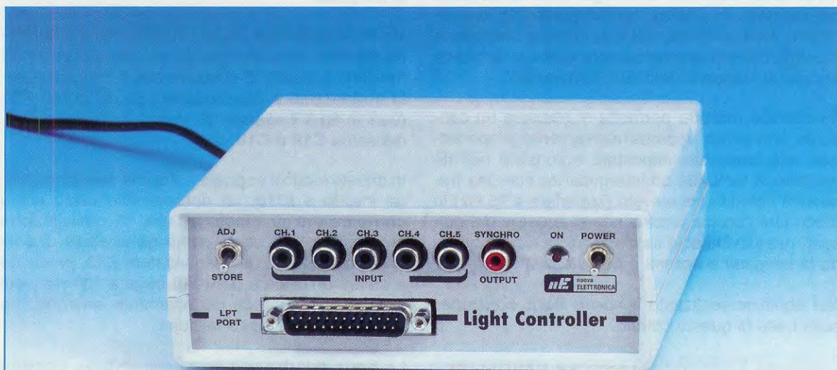
Fig.1 Foto del circuito per Light Controller siglato LX.1613 già collocato nel suo mobile plastico. Dalla mascherina anteriore escono il connettore maschio da collegare tramite cavo alla porta parallela del computer e le 6 prese RCA della scheda I/O siglata LX.1614.
